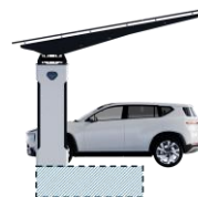
Betonfundamente (Ortbeton oder Fertigteil)
